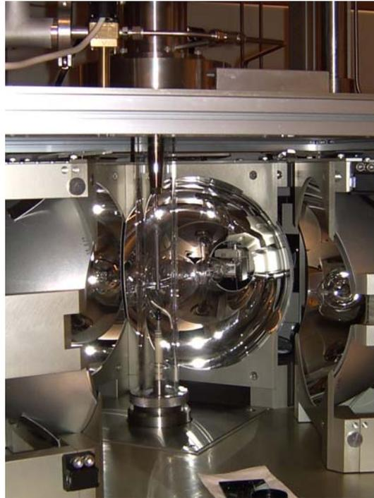
Abb.2.: Detail der Zugvorrichtung des 4-Spiegel – Ofens, Vakuum- bzw. Hochdruckfederbalgabdichtung:
