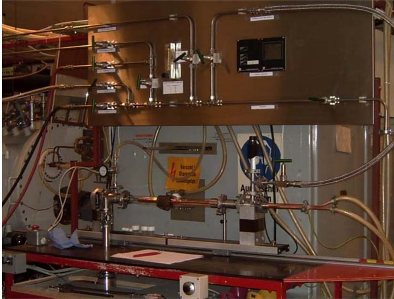
Abb.4.: Hukin Tiegel, Cold-cruzible, zur Herstellung größerer Mengen polykristalliner Materialien in „Knopfform“:
