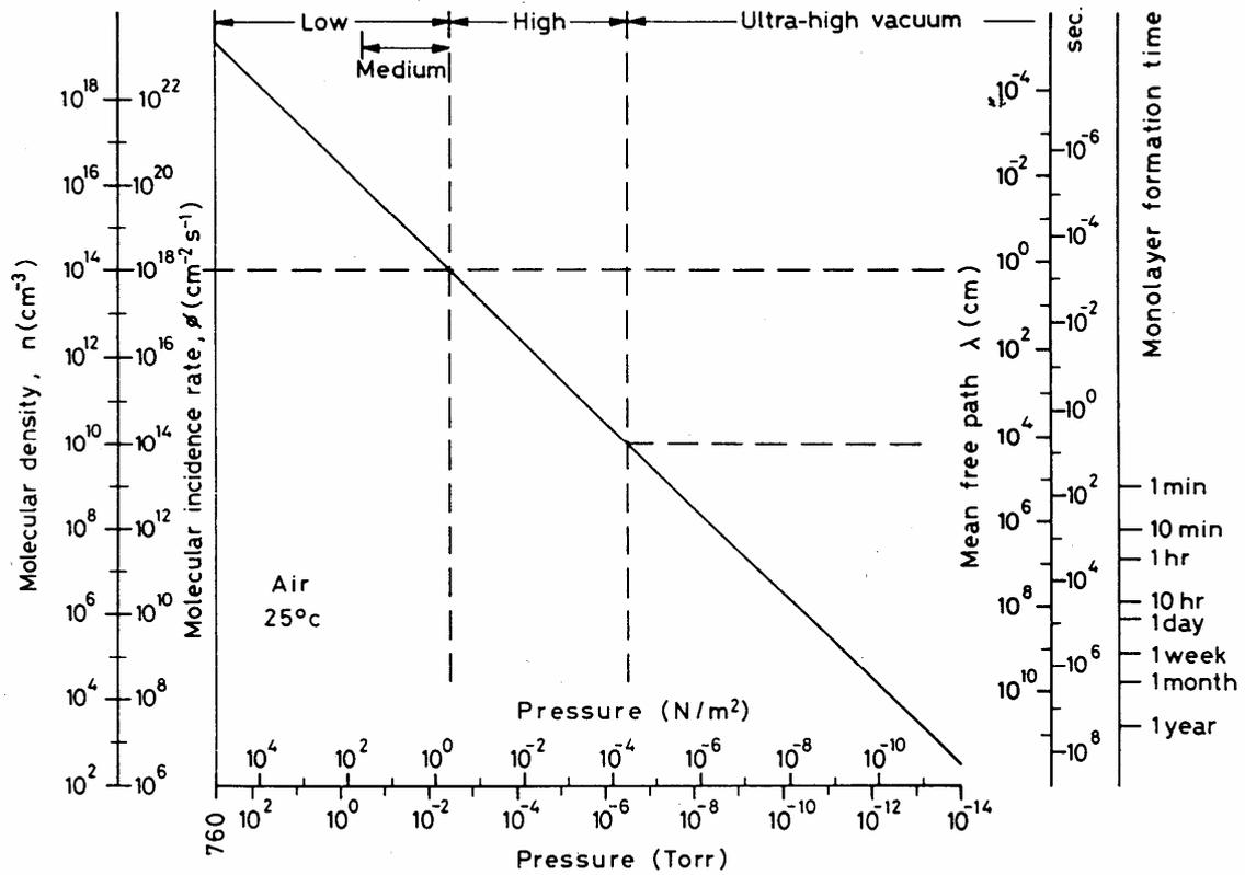
Zeit für die Bildung einer Monolage in Abhängigkeit vom Umgebungsdruck:
