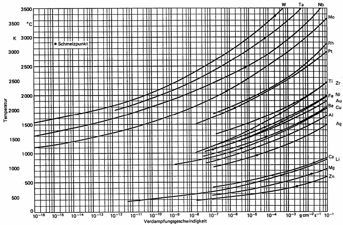
Verdampfungsgeschwindigkeit im Hochvakuum in Abhängigkeit von der Quelltemperatur
